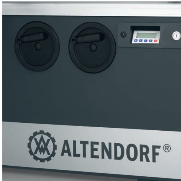
Le réglage de la hauteur et de l'inclinaison s'effectue très aisément grâce à deux manivelles rabattables.
